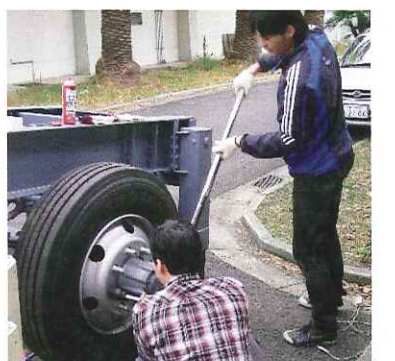
大型車の車輪脱落事故の安全管理技術に関する研究のため、トラックを使ったねじの締め付け実験を実施<写真提供:福岡俊道氏>
