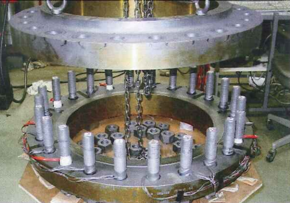
(写真上)内径が約50cmで石油配管に広く使用されているフランジ。重さが1組(2枚1組で使用)で約280kg。ねじの外径が33mmのボルトを24本使って締め付ける<写真提供:福岡俊道氏> (写真左)大きさと用途、頭部やねじ山の形状の違いなど、ねじにはたくさんの種類がある<写真提供:福岡俊道氏>
