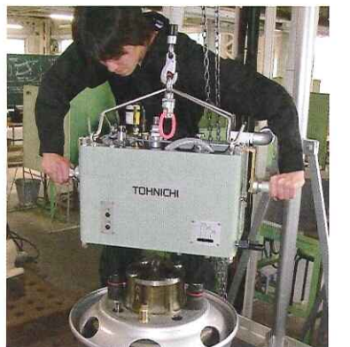
2軸同時締め付け装置の試作品 <写真提供:福岡俊道氏>
