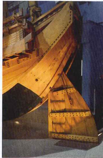
樽詰めの酒を専門に運んだ樽廻船(縮尺1/5)模型。写真左は船尾にある「かじ」。取り外しができるようになっていた。写真右は船尾側から見たもの。写真下は船首方向から見た同船(船の科学館所蔵)
