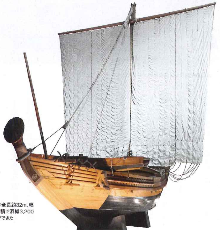
樽詰めの酒を専門に運んだ樽廻船(縮尺1/5)模型。写真左は船尾にある「かじ」。取り外しができるようになっていた。写真右は船尾側から見たもの。写真下は船首方向から見た同船(船の科学館所蔵)
