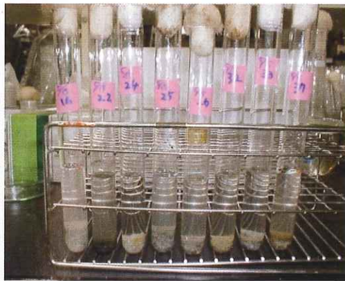
PETフィルムをエサにバクテリアを試験管で培養。PETは2つの化合物が、互いに鎖のようにつながった構造で、非常に安定した分子構造になっているため、いったんPETを260度に加熱し、結晶構造を崩してから、バクテリアに分解させる(写真提供:小田耕平氏)
