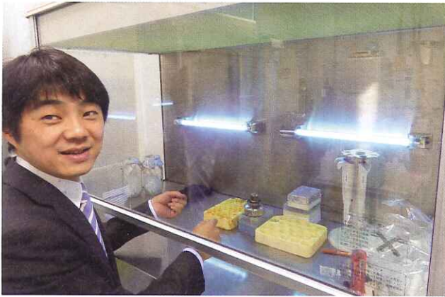
(写真上) 無菌操作をするための装置クリーンベンチ
