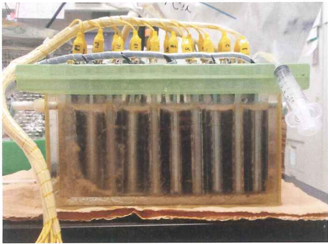
廃水処理で用いた容積約1Lの微生物燃料電池装置。省エネ型の廃水処理が可能になると期待されている(写真提供:渡邊一哉氏)
