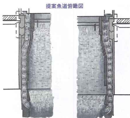
提案魚道俯瞰図 安田先生のスケッチ画。アユの迷入対策を考慮した台形断面魚道からの流れと堰(頭首工)からの流れとのつながりの工夫を描いたもの(画像提供:安田陽一氏)
