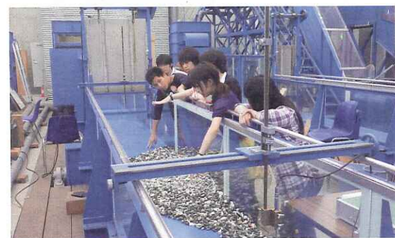
環境水理実験室内で実施した礫洲に関する実験準備の様子(写真提供:安田陽一氏)
