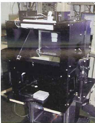
実験のセットアップ。サルは画面 を見ながら手を伸ばして物をつ かむ課題や動画を見る課題がで きるように訓練されている。その 課題中の脳の神経細胞の電気 的な活動をオシロスコープ(写真 左下)を使って観測し、コンピ ューター(写真右下)に取り込む(写 真提供:村田哲氏)
