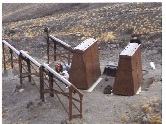
(写真上)ミュオン検出器の写真。これを2つ組み合わせると検出器を構成する(画像提供: 田中宏幸氏)
