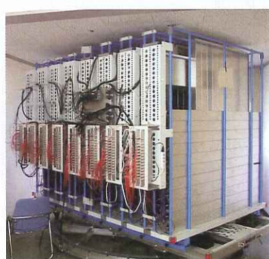
(写真上)ミュオン検出器の写真。これを2つ組み合わせると検出器を構成する(画像提供: 田中宏幸氏)
