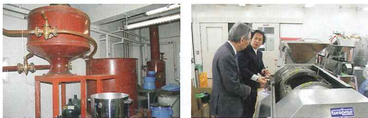
(写真左)蒸留酒のブランデーを製造する機械。フランスから輸入した銅製のもの。(写真右)山梨大学ワイン科学研究センターは、国立大学法人では唯一の果実酒類製造免許を持っている。果実酒類の製造のために、一連の醸造機械が装備されている
