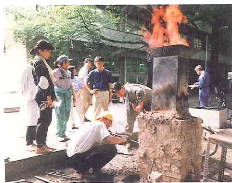
レンガを使って現代風にアレンジしたたたら の 炉。鉄をつくらせている様子<写真提供:永田和宏氏>
