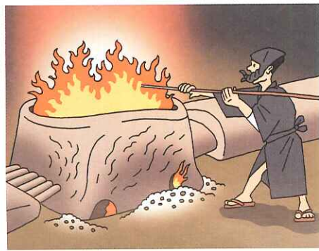
たたら吹き の 炉。砂鉄と木炭から玉鋼をつくらせていく
